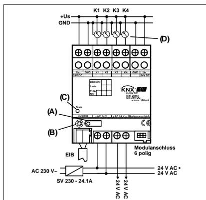
**Anschluss****+US:** Versorgung externer Sensoren**GND:** Bezugspotential für +US undEingänge
