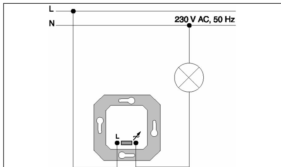
**Anschluss in Wechselschaltung nicht möglich.**
