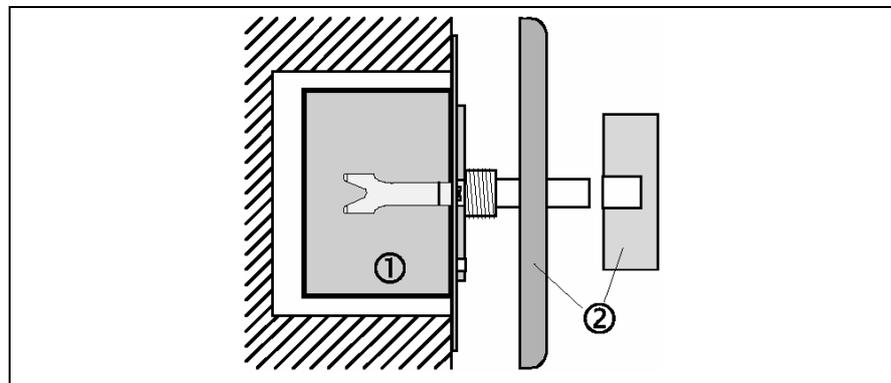
**Der Dimmer wird in einer Gerätedose nach DIN 49073 montiert.**
