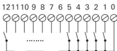
2. Schließen Sie die Klingeltaster an. Die maximale Leitungslänge beträgt 2 m.
