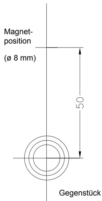
Bild 17: Bohrshablone Magnetposition im Türblatt
