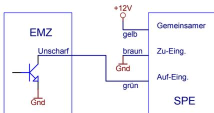
Bild 10: Anschaltbeispiel (0V-aktives Unscharf-Signal)
