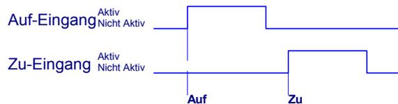
Bild 6: Signalverlauf
