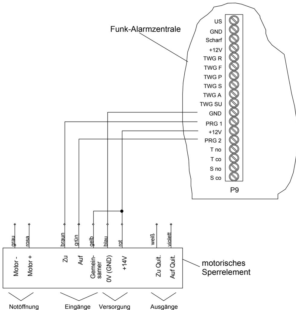
Bild 4: Anschluss des Sperrelements an die Funk-Alarmzentrale
