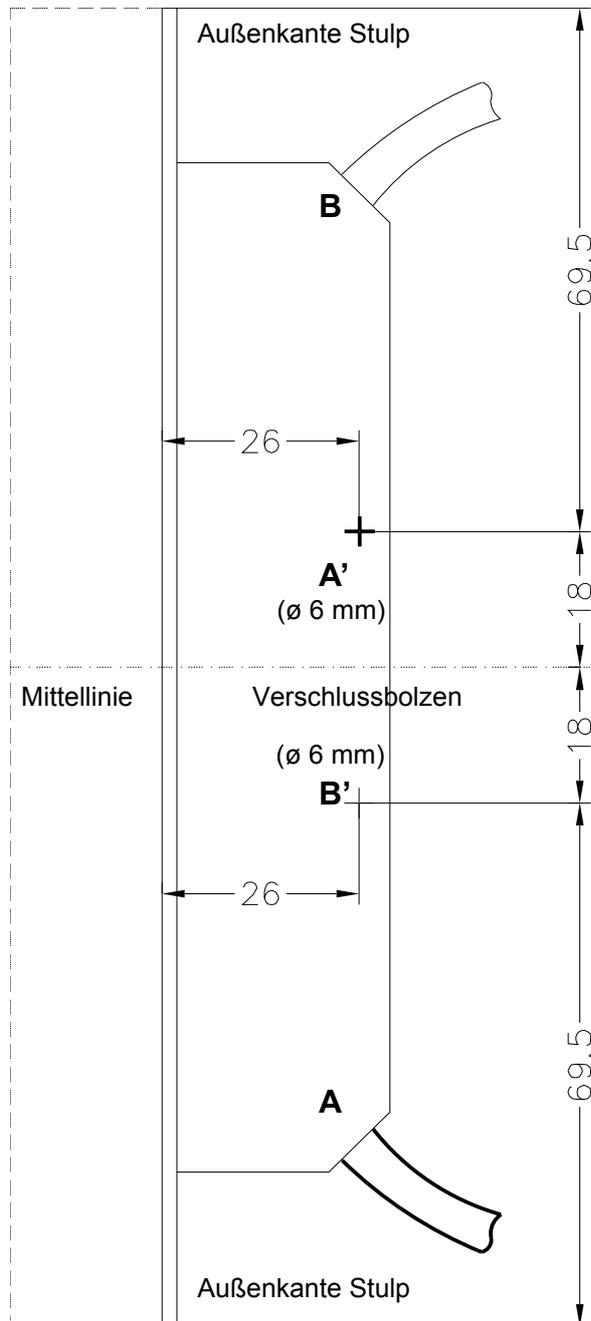
Bild 16: Bohrshablone Notöffnung Bohrung (ø 6 mm) je nach Position der Kabeleinführung (A) oder (B) an Punkt A' oder B' vornehmen
