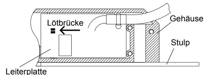
Bild 15: Lötbrücke Türüberwachung
