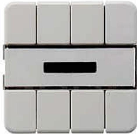
Der (IR-) Lichtszenentastensensor Komfort sendet bei Tastenbetätigung Telegramme auf den *instabus* EIB, welche bei Aktoren entsprechende Funktionen auslösen. Je nach geladener Applikation können bis zu 8 Lichtszenen gespeichert und wieder abgerufen werden bzw. 4 Telegrammfolgen mit maximal 8 Ausgängen erzeugt werden.
