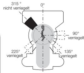
Der Schließer des Profil-Halbzyinders kann durch hineindrücken des seitlichen Bolzens in 45° Schritten verstellt werden.
