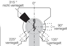
Der Schließer des Profil-Halbzyinders kann durch hineindrücken des seitlichen Bolzens in 45° Schritten verstellt werden.
