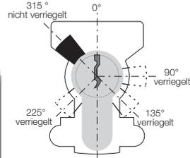
Der Schließer des Profil-Halbzyinders kann durch hineindrücken des seitlichen Bolzens in 45° Schritten verstellt werden.
